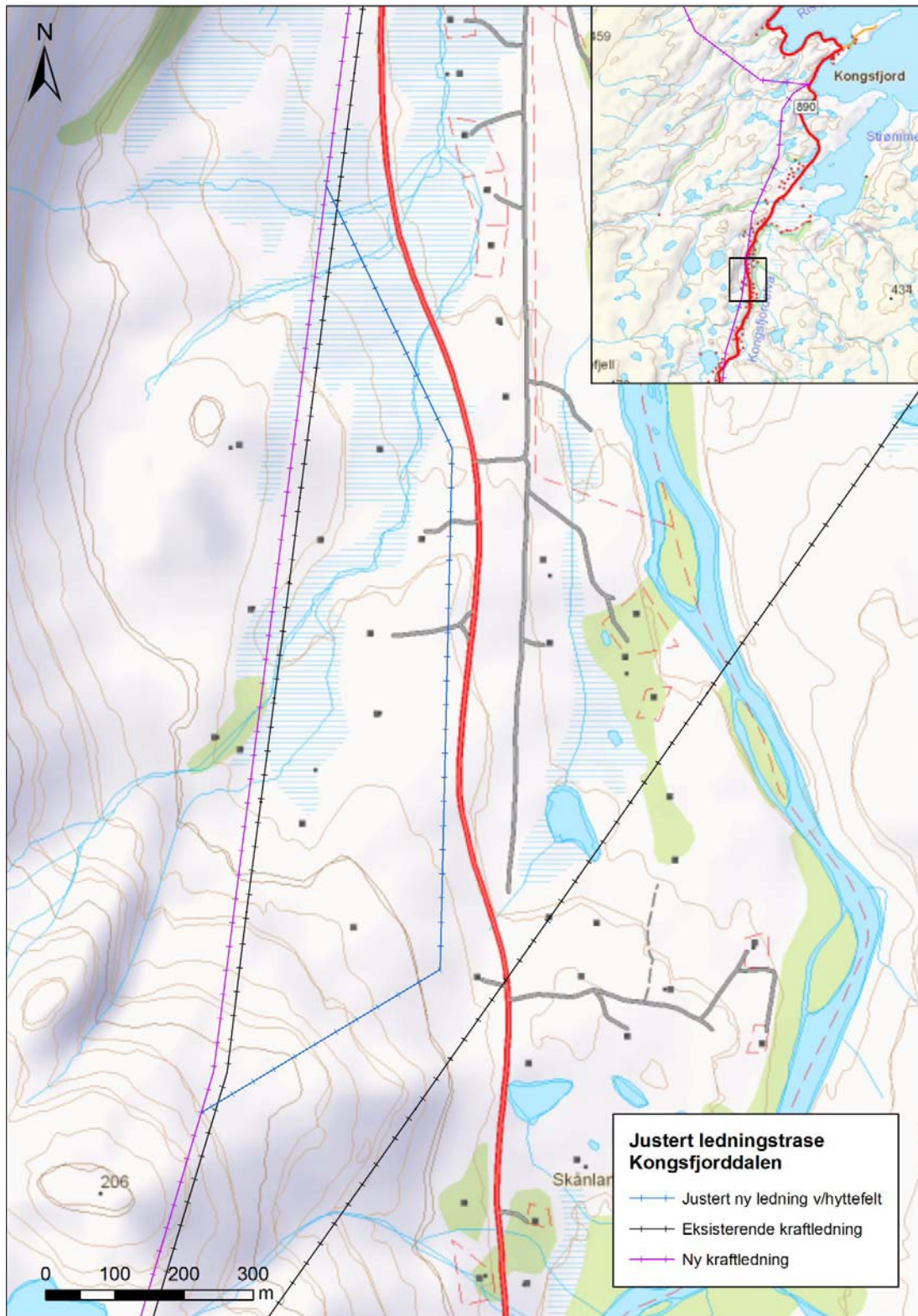
Figur 6-1 Endring av trasé rundt hyttefelt i Kongsfjorddalen. Ny trasé er tegnet med mørkeblått. Opprinnelig trasé: 1504 m, ny trasé: 1608 m. Kart: Sweco/VKN.
