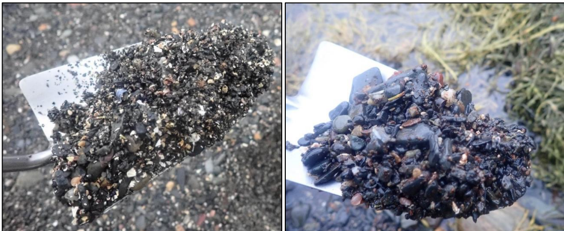
Figur 7. To av sedimentprøvene fra stasjon M2, prøvetatt med hagespade. Stasjonen bestod av grove sedimenter dominert av grus, stein og skjellsand og tett vekst av tang. Mer finkornet sediment ble påtruffet i et område som lå bak et bart berg.
