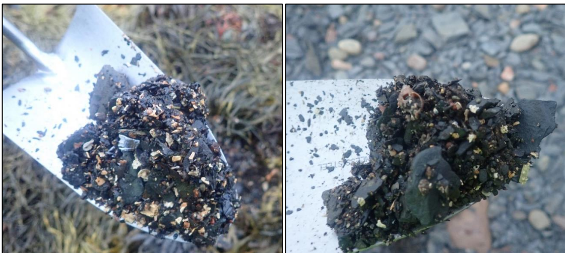
Figur 8. To av sedimentprøvene fra stasjon M3, prøvetatt med hagespade. Stasjonen bestod av grove sedimenter dominert av stein, grus og berg i dagen, samt mye tang.
